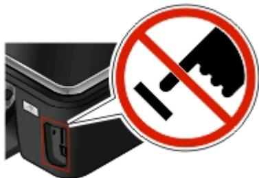
**警告—可能的损坏:** 当正在打印、读取或写入存储设备时,请不要触摸任何电缆、任何网络适配器、任何接口、存储设备或图中所示的打印机区域,否则可能会发生数据丢失。
