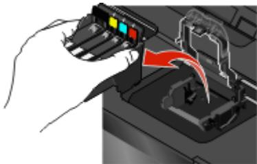
**3** 使用一块干净且不掉毛的布擦洗打印头触点。
